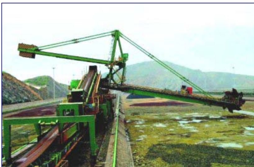
Foto 2: Empilhadeira e recuperadora de graneis sólidos típica
