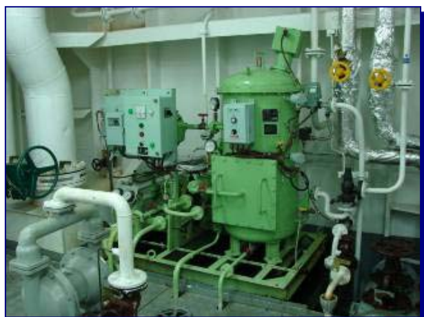
Foto 5: Sistema de separação de água e óleo presente na draga.
